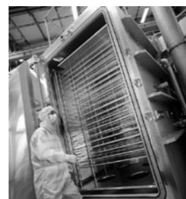
Chambre de chargement d'un système de dépôt de cellules en couches minces de Si. (IMT)
