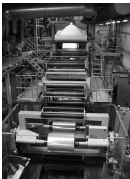
La ligne d'enduction silicone Valtec 4 de Gascogne Adhésive
